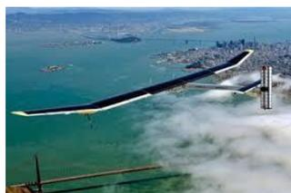
阳光动力号飞机刚刚完成了它的全球飞行，而且全程没有使用一滴燃油！它于 2015 年 3 月 9 日从 Abu Dhabi 出发飞向亚洲，并于 2016 年 7 月 26 日在原出发地结束了它的飞行。该项计划承载着人们希望发展耗能更少，更轻便和符合空气动力学的飞行模式的美好意愿。综合的设计材料使它基本上仅借助于太阳能来提供昼夜不间断飞行的能量。唯一的缺憾是，它的飞行速度相比传统飞机要慢很多。然而，通过这次飞行壮举，阳光动力号获得了包括最长自动飞行在内的 8 项纪录。该项目也证明了将传统能源过渡到对环境友好的清洁能源并非不可能。
